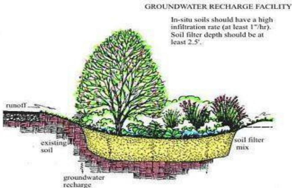
Fig. 16 – Célula de biorretenção
